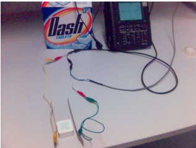
Fig. 3 Test opstelling voor het meten van capaciteit . De 2 geleiders zijn verbonden met de oscilloscoop en de functiegenerator. De frequentie staat op een blokgolf en 1kHz afgesteld.
